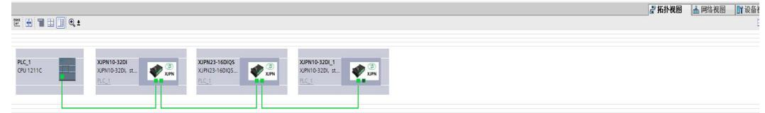
编译后下载配置，转至在线后，线条都显示绿色，且在线有打勾标记，则实际模块型号、接线与组态配置无异；反之，则实际模块型号、接线与组态有差异，且模块的 SF、MT 灯常亮，表示网络诊断出现差异，需要维护、维修。
