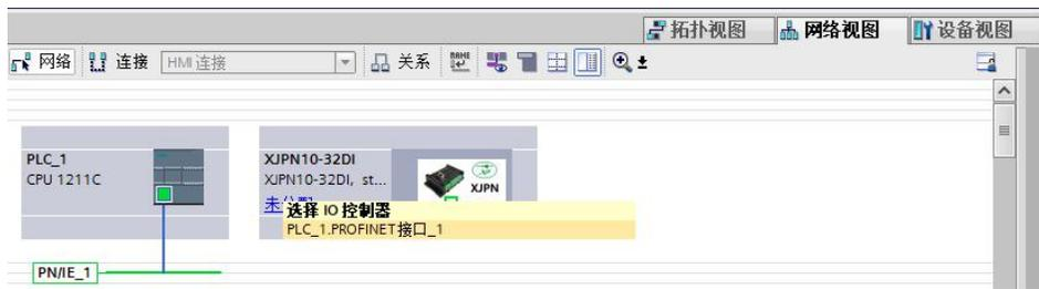
在其他现场设备/PROFINET IO/IO/XJKJ PN/DSTB 目录下选择 XJPN10-32DI 并拖拽到配置界面下，点击“未分配”选择与之网口连接的 PLC 的 PROFINET 接口，见下图：
