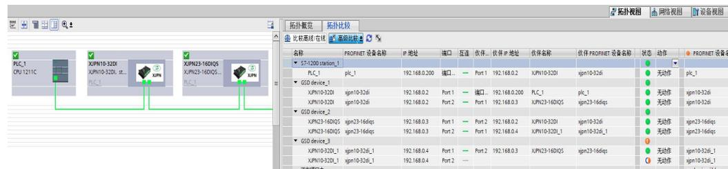
**注意：**若 PLC 只有一个 PN 口，调试/监视电脑需要实时监测数据，则最好使用西门子交换机；若使用其它厂家交换机，PLC 是不能够识别到它，网络诊断会出现差异。若不使用网络诊断功能，交换机也可以使用非西门子厂家的交换机，模块的 MT、SF 指示灯将不起任何指示作用。
