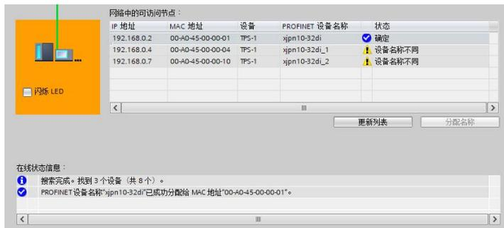
上图可以看到设备名称已经分配给对应的模块，模块的 IP 地址也由硬件配置中预
