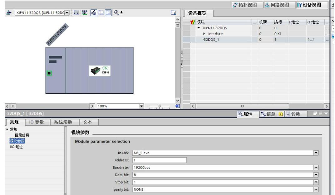
在“设备视图”中点击“-32DQS\_1”进入模块参数设施界面，其中包含 RS485 协议类型、站地址、波特率、数据位、停止位、校验位。
