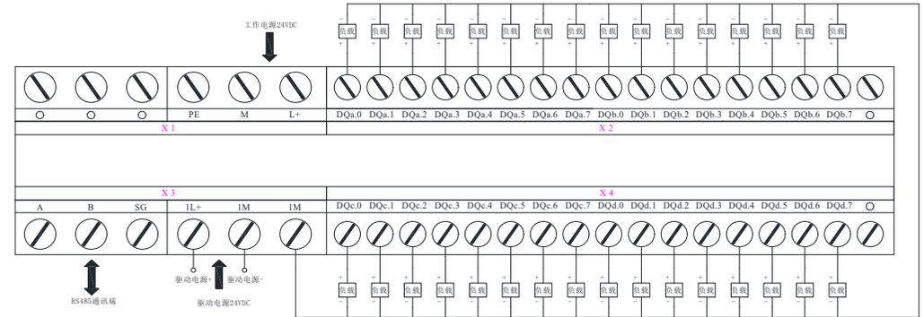
**输出方式：PNP（高电平输出）；DQ 驱动电压：外部供电 24VDC，电压范围 10~48VDC；**
