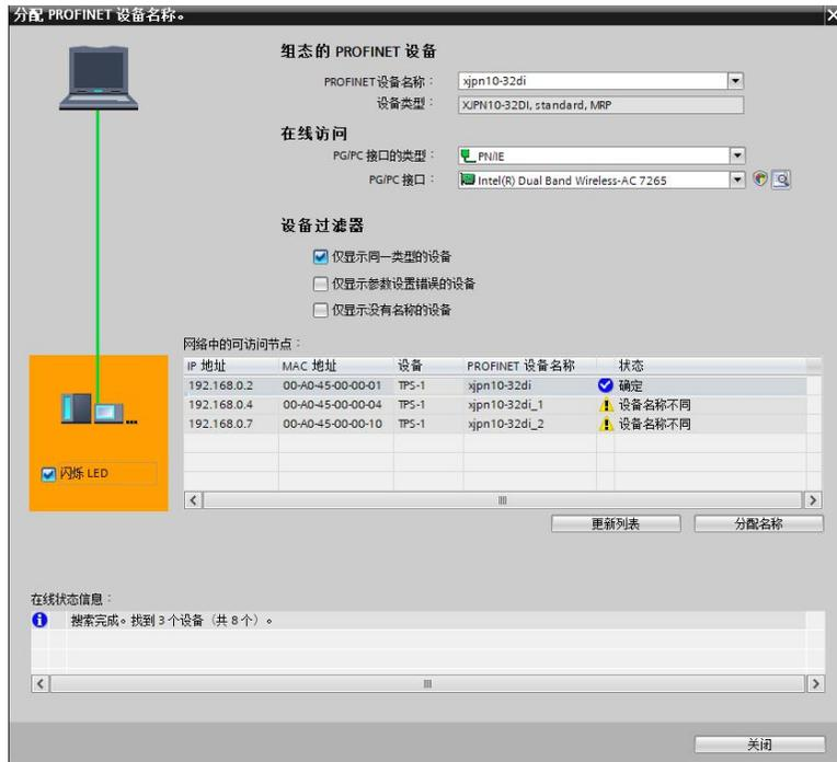
若同一网络拥有同型号模块，先单击对应设备，再勾选闪烁 LED，此时可以看到模块的网口 P1、P2 的绿、黄灯同时闪烁。此模块就是即将被分配设备名称的模块。确认无误后，点击分配名称按钮，稍后提示设备名称成功分配信息，最后再更新列表，被分配名称的模块名称已按照组态时的名称命名了。
